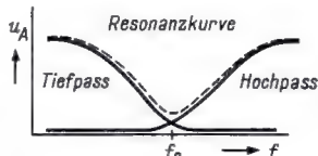
Bild 3. So kommt die Resonanzkurve eines Doppel-T-Gliedes zustande
