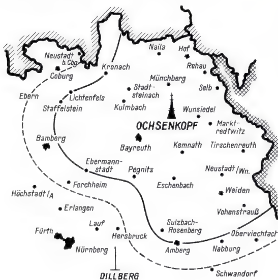
Bild 2. Das voraussichtliche Versorgungsgebiet des neuen Fernseh-Großsenders Ochsenkopf; die ausgezogene Kontur bezeichnet die Feldstärkekurve für 2 mV/m, die gestrichelte Linie den Streubereich
