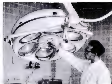
Bild 3. Im Zentrum der Operationsleuchte befindet sich das Objektiv der kleinen Vidikon-Fernsehkamera
